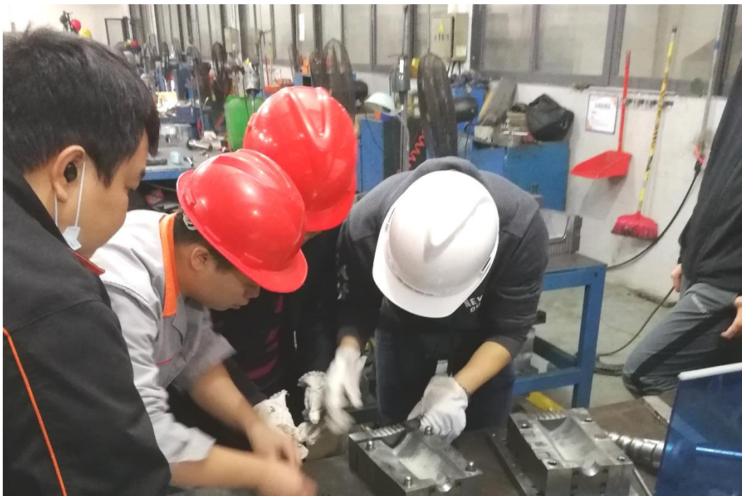
图 5 现代学徒制在岗学员在完成模具拆装典型工作任务
